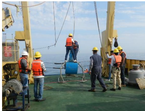
Figura 3.1. Armado y lanzamiento de nucleador de caja.
