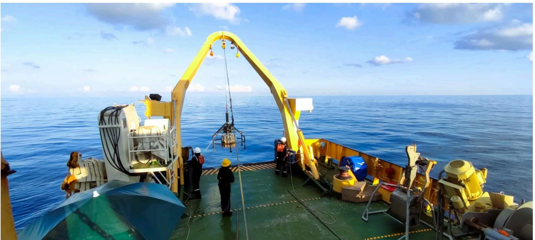
**Figura 10.** Recuperación de muestras de sedimento colectado con el multinucleador con apoyo del marco A en la popa del B/O *Justo Sierra* de la UNAM. Imagen Coordinación de Plataformas Oceanográficas.
